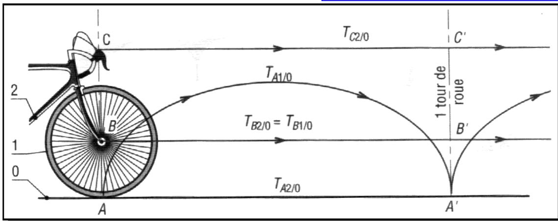
A est le point de contact entre la roue (1) et le sol (0). B est le centre du moyeu entre le cadre et la roue. C est un point appartenant à une poignée de frein. Le vélo se déplace en translation rectiligne.
