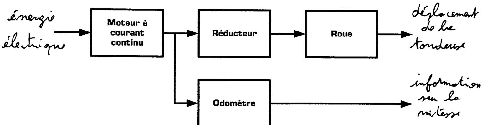
On remarque que : l'odomètre est monté à la sortie du moteur, et non à la sortie du réducteur.
