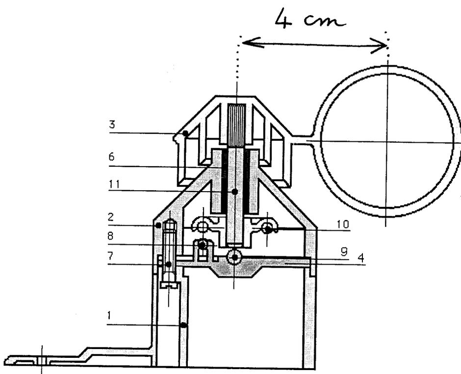
Figure 5 : les 11 éléments principaux de l'anémomètre
