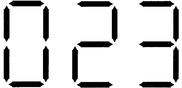
Affichage de la vitesse du vent en valeur entière sur 3 chiffres
