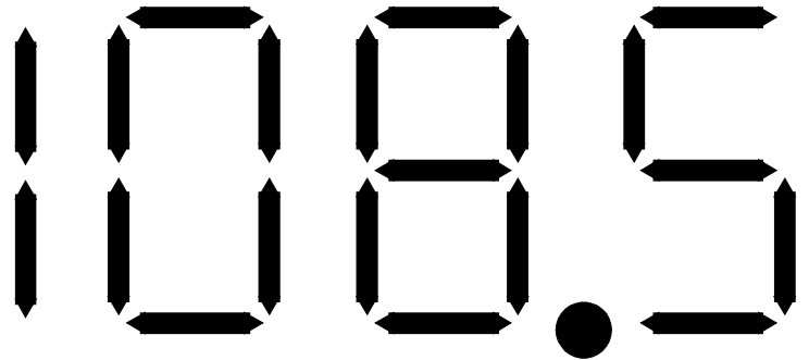
Affichage de la vitesse du vent en valeur décimale [précision 0.5 km.h -1 ] sur 4 chiffres
