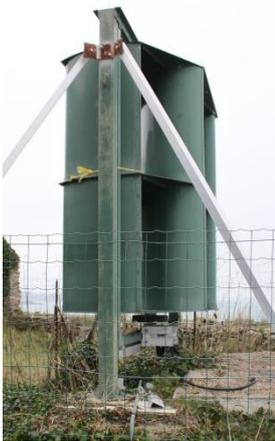
L'aérogénérateur est une machine qui a pour fonction de prélever une partie de l'énergie éolienne disponible pour la transformer en énergie électrique. L'éolienne du fort du Guesclin est de type "Savonius". Son installation au niveau du sol ne dégrade pas le panorama de ce site classé. L'absence de pylône diminue le volume des fondations. Son implantation au Nord Est de l'île est adaptée pour capter les vents thermiques réguliers de l'été.
