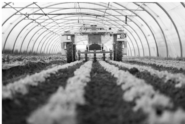
Figure 1 : robot de désherbage à guidage autonome
