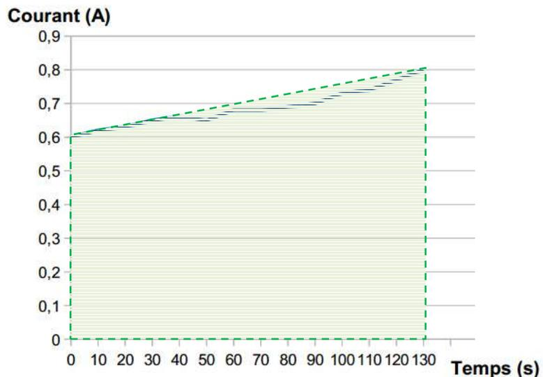
La valeur moyenne du courant peut donc être déterminée en divisant l'aire du trapèze obtenu par la durée d'observation (130 secondes pour la montée du ballon).
