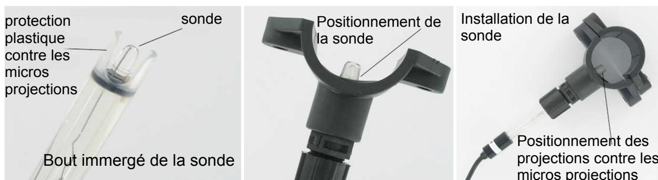
Figure 3 : montage de la sonde pH.
