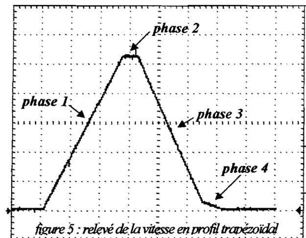
figure 5 : relevé de la vitesse en profil trapézoïdal
