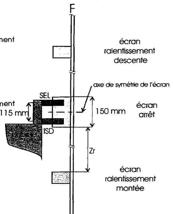
figure 3 : capteurs optiques
