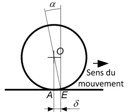
**Q14)** Dans ces conditions, préciser s'il y a roulement sans glissement de la roue sur le sol. Justifier la réponse.
