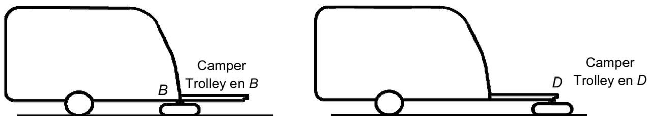
**Q13)** En utilisant, au point  $A$ , le théorème du moment statique (principe fondamental de la statique) appliqué à la caravane, déterminer la valeur de  $B_y(\text{trolley} \rightarrow \text{caravane})$  dans le cas où le Camper Trolley est fixé au point  $B$ . Déterminer la valeur de cette même action dans le cas où il est fixé au point  $D$  (voir ci-dessus). Expliquer pourquoi le fait de choisir le point  $B$  permet d'améliorer l'adhérence du Camper Trolley sur le sol.
