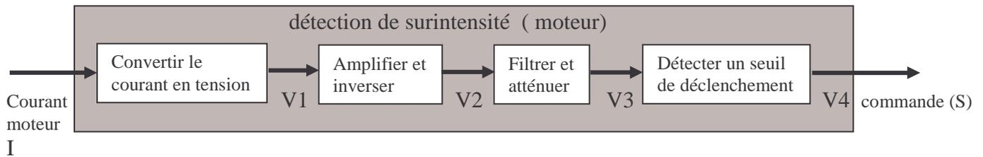
☛ L'équation de la fonction « convertir le courant en tension » est  $V1 = I / 10$
