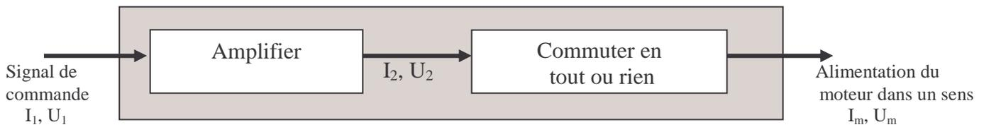
La fonction « commuter en tout ou rien » est réalisée par un dispositif à 4 relais. Le moteur doit être commandé dans les 2 sens de rotation.
