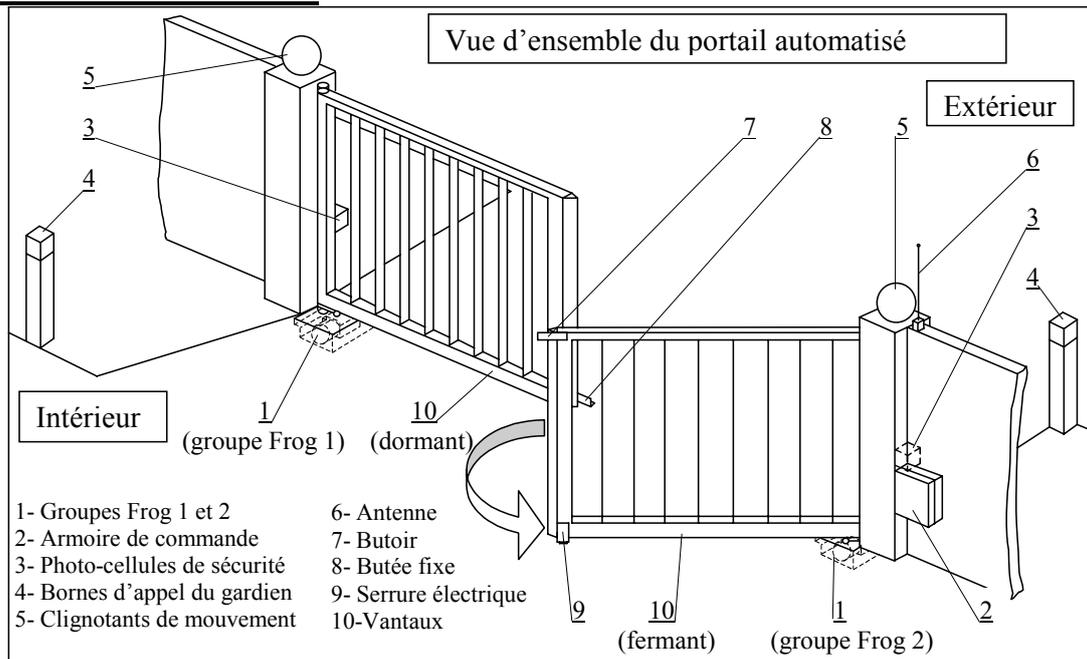
Le portail automatisé présenté ci-dessus est installé à l'entrée principale d'une cité scolaire. Il autorise les entrées et les sorties des véhicules.
