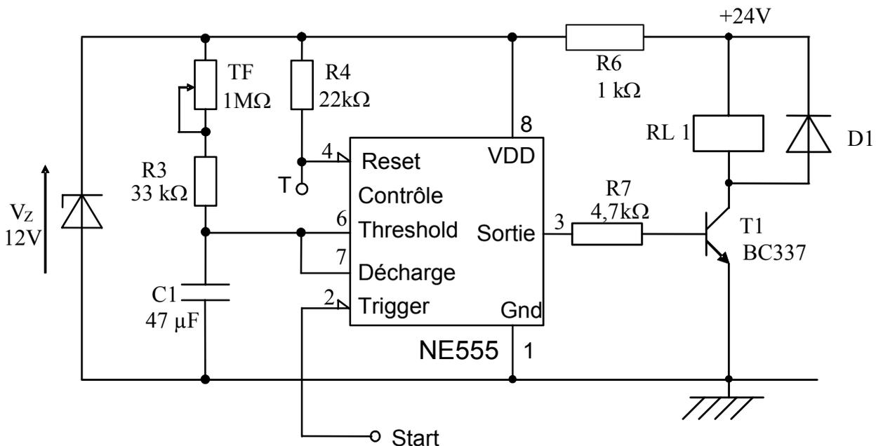
*(RL1 est la bobine d'un relais qui est associé au contact situé sur le schéma p 7/12)*
