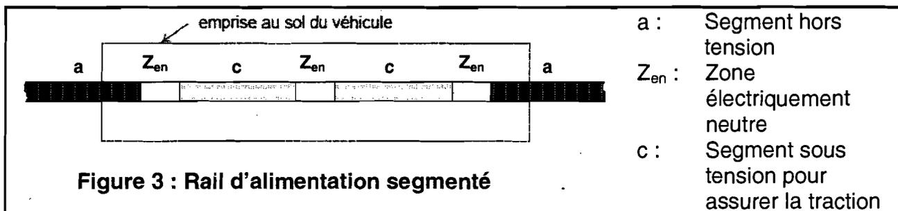
Hors présence de la rame, les segments sont mis hors tension et reliés au potentiel 0 V. Dans son état par défaut, le rail d'alimentation est donc inerte et ne présente aucun risque électrique pour le public ou les autres véhicules.
