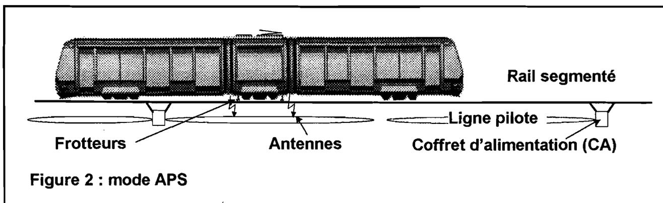
Pour des raisons évidentes de sécurité, le rail d'alimentation intégré à la plate-forme de roulement est segmenté afin que seule la zone sous la rame soit sous tension (voir Figure 3).
