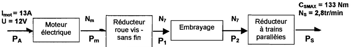
– **Juste avant le patinage**, l'arbre de sortie du réducteur tourne encore à  $N_s = 2,8\text{tr/min}$  et on admet que le couple disponible est le couple de patinage  $C_{S_{MAX}}$ . **Sur votre copie**, en déduire la puissance mécanique  $P_s$  (puissance en sortie du réducteur) fournie à la manivelle 4.
