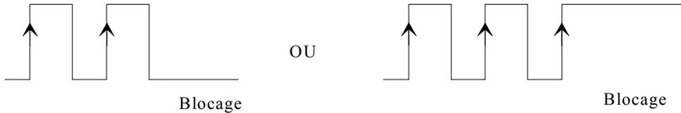
L'intervalle normal entre deux fronts montants étant de 60 ms, on considère qu'il y a présence d'un obstacle (Spo), si aucun front montant n'apparaît 70ms après le dernier.
