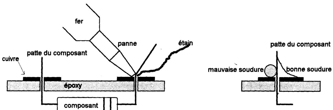
☞ Une bonne soudure présente l'aspect d'un cône brillant, lisse et étalé. Une soudure trop rapide laisse une boule d'étain collée, sans vrai contact avec les composants.
