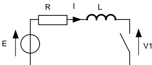
$R$  et  $L$  modélisent la bobine avec sa résistance et son inductance.  $E$  est la tension continue d'alimentation, ici elle est de 15 V.  $I$  est le courant traversant le circuit.  $V_1$  est la tension aux bornes de l'interrupteur.
