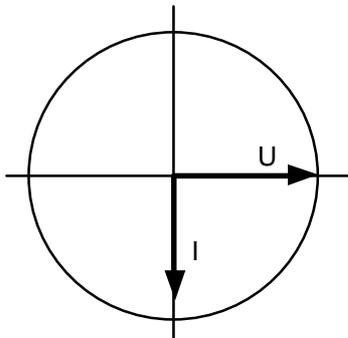
Les grandeurs sinusoïdales peuvent être représentées par des vecteurs tournants. Fresnel, ne s'intéressant qu'au déphasage, stoppe la rotation des vecteurs.
