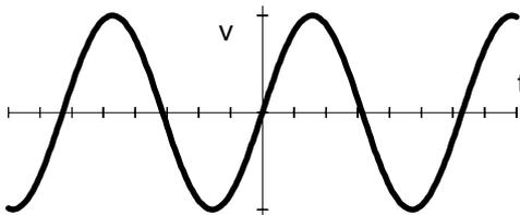
Un oscilloscope montre l'évolution d'une tension en fonction du temps.
