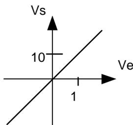
Un amplificateur audio peut être considéré comme un quadripôle. Supposons que son coefficient d'amplification soit de 10, sa caractéristique d'entrée sortie sera représentée par la figure ci-contre.
