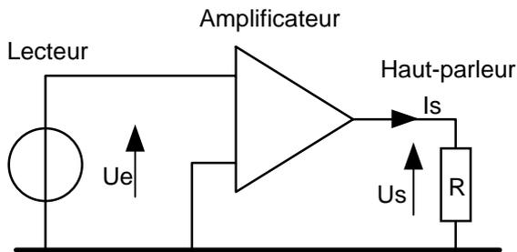
l'amplificateur est chargé de multiplier la tension d'entrée par un coefficient supérieur à 1.
