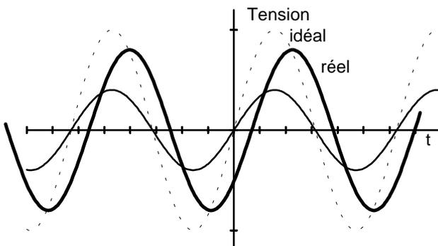
L'amplificateur réel possède une résistance d'entrée non infinie et une résistance de sortie non nulle.
