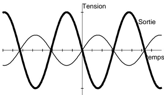
Ici, une autre différence par rapport à l'amplificateur précédent : la tension de sortie est inversée. On dit que l'amplificateur est **inverseur**.
