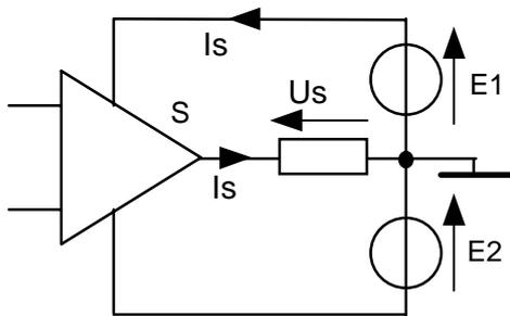
Les générateurs E1 et E2 sont branchés de part et d'autre de la masse. On obtient ainsi une alimentation symétrique c'est à dire une tension positive et une tension négative par rapport à la masse.
