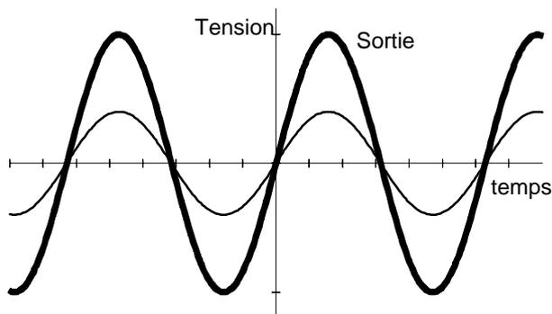
la tension de sortie a même forme et même fréquence que la tension d'entrée, seule l'amplitude change.
