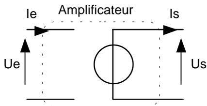
Les caractéristiques sont résumées par la modélisation ci-contre. On distingue deux parties dans un amplificateur : l'étage d'entrée qui reçoit le signal à amplifier et l'étage de sortie qui fournit la tension adaptée à l'utilisation que l'on veut en faire.
