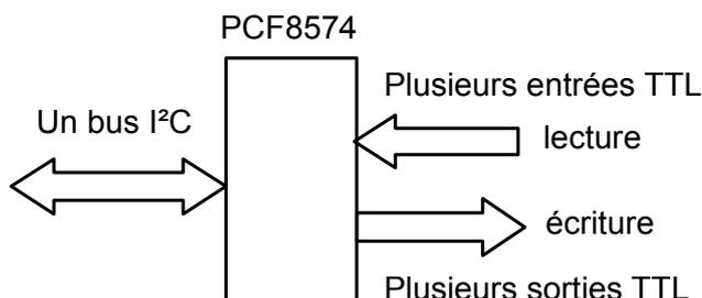
Le composant est dit quasi bidirectionnel car une broche TTL peut jouer soit le rôle d'une entrée soit le rôle d'une sortie alternativement mais pas les deux à la fois (c'est évident !)
