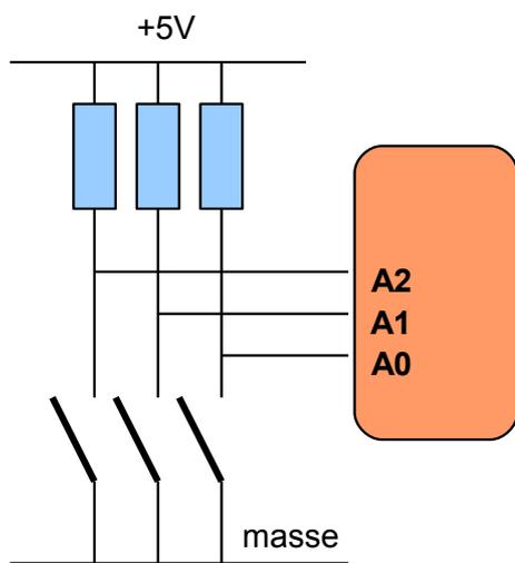
Le dispositif se compose de trois résistors de rappel, et de trois interrupteurs.
