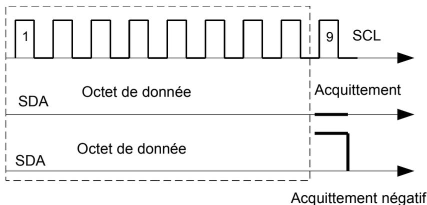
Exemple de schéma mis en œuvre pour une liaison avec un LM75
