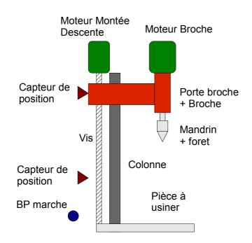
Perceuse automatique. Elle réalise un perçage et revient en position initiale.
