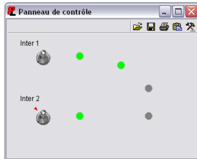
Un clic sur les interrupteurs les fait basculer, les voyants changent d'état en fonction des caractéristiques du montage.
