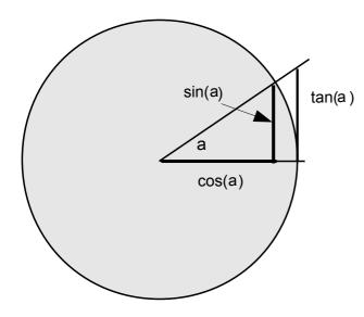
Le cercle trigonométrique est un cercle de rayon unité qui permet de déterminer graphiquement les fonction trigonométriques d'un angle. Pour des raisons pratiques, on prendra un cercle de rayon 100 mm pour n'avoir qu'une division par 100 à effectuer.
