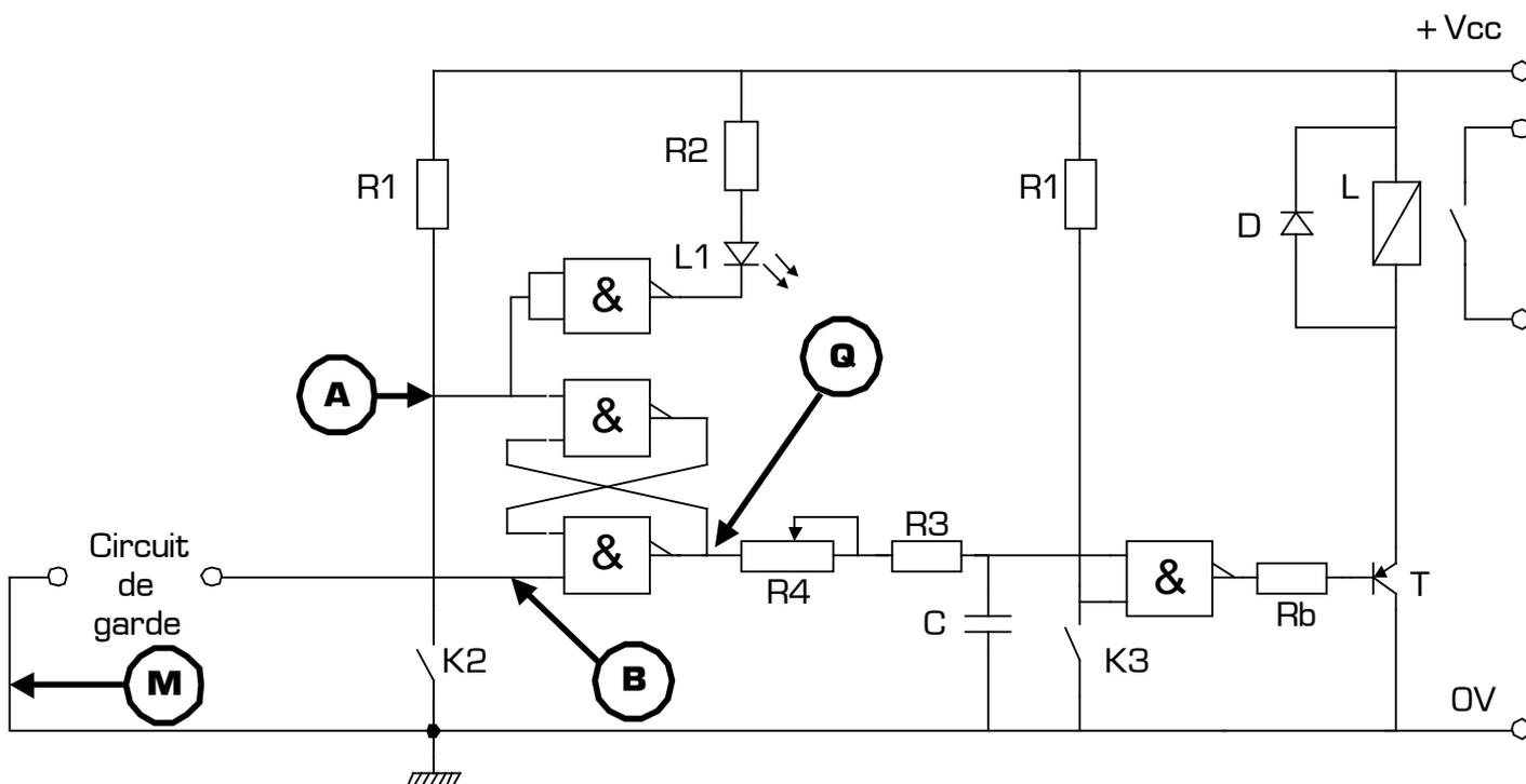
On appelle A et B les 2 entrées de la bascule, et Q sa sortie principale.
