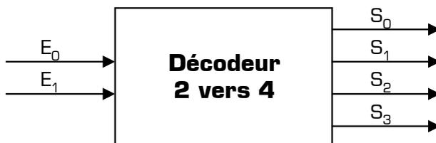
Ce décodeur possède 2 entrées et 4 sorties. Une seule sortie est activée à la fois [par un état haut] : celle dont l'indice [entre 0 et 3] correspond au nombre [sur 2 bits] appliqué en binaire sur les entrées.
