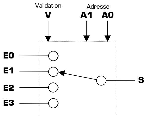
*Le multiplexage consiste à envoyer sur une même ligne de transmission des informations provenant de sources différentes*
