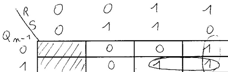
$$Q_n = \bar{R} \cdot Q_{n-1} + \bar{S} \cdot \bar{Q}_{n-1} = \bar{R} \cdot (Q_{n-1} + \bar{S}) \rightarrow \text{équation de la fonction mémoire}$$
