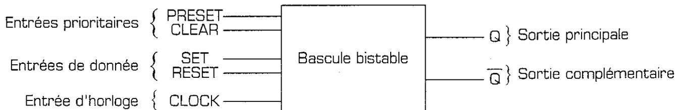
**Clear** : une impulsion sur cette entrée met à ZERO la bascule quelque soit l'état des entrées de donnée et d'horloge :  $Q = 0$
