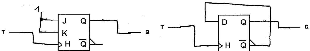
Pour réaliser une bascule T avec une bascule JK, on utilise le mode de fonctionnement « basculement » [J=K=1], et pour réaliser une bascule T avec une bascule D on relie D à la sortie complémentaire.
