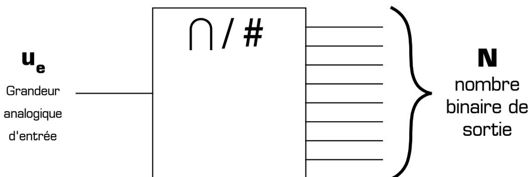
Figure 2 : Symbole de la fonction Conversion Analogique / Numérique
