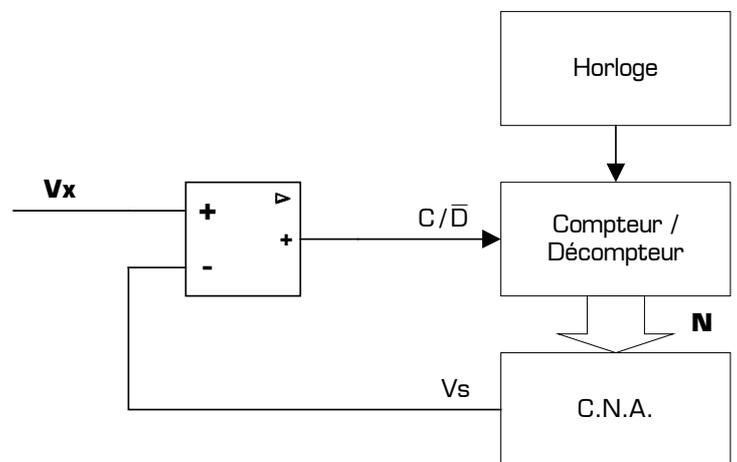
Figure 5 : Principe du C.A.N. à poursuite
