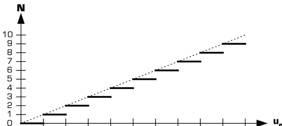
Figure 3 : Caractéristique de transfert d'un C.A.N.
