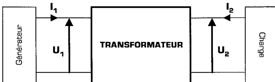
Figure 5 : Transformateur en fonctionnement
