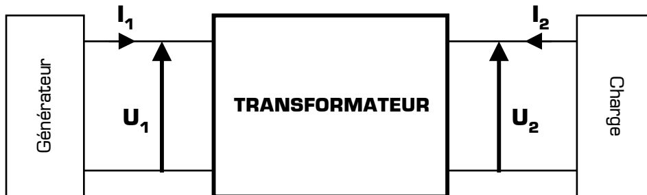
Figure 5 : Transformateur en fonctionnement
