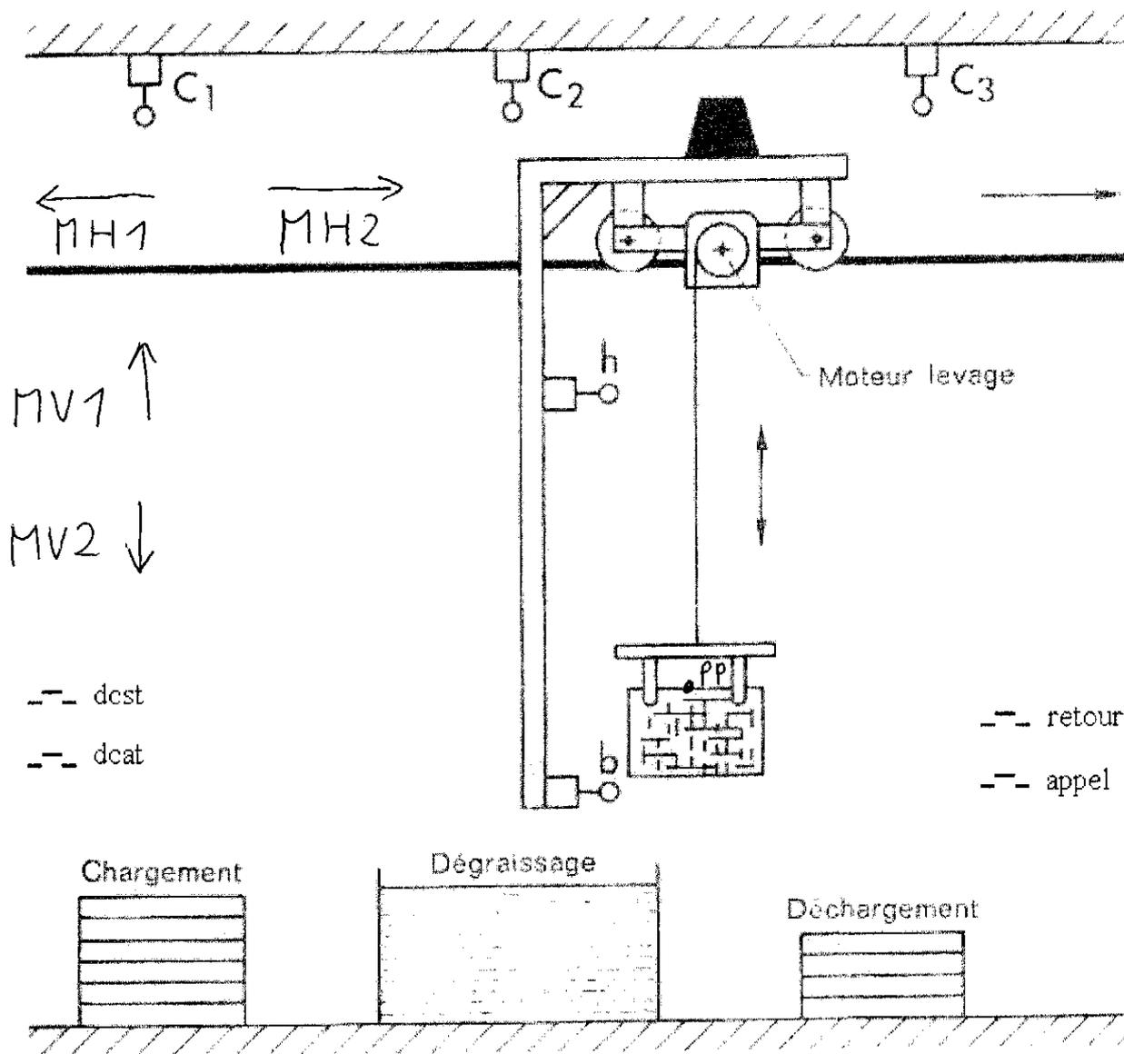
Le poste de dégraissage est entièrement mécanisé : un panier, suspendu à un chariot, descend dans la cuve de dégraissage les pièces à traiter, attend 30s et les ressort.
