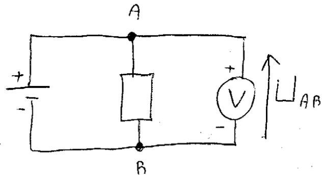
Branchement du voltmètre et flèche de tension
