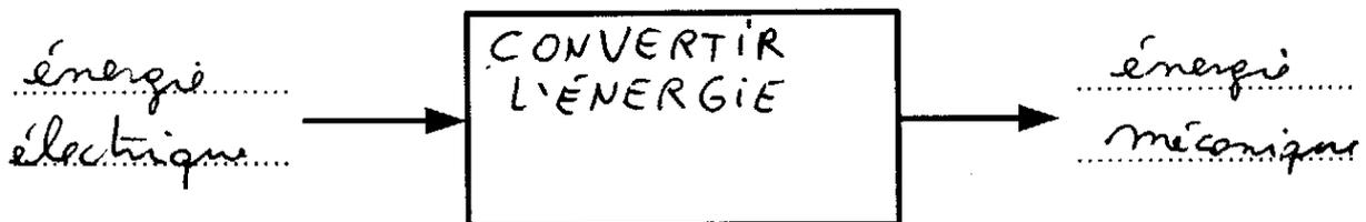
Le moteur électrique est le plus utilisé des actionneurs électriques du fait de sa simplicité. Il est principalement constitué d'un **stator** [partie fixe] comportant les bobinages créant les champs magnétiques, et d'un **rotor** [partie tournante] au centre du stator se terminant par **l'arbre de sortie** du moteur
