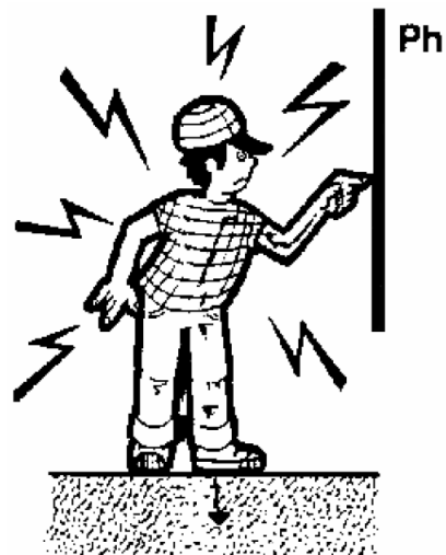
Contact direct : l'utilisateur touche directement des conducteur sous tension
