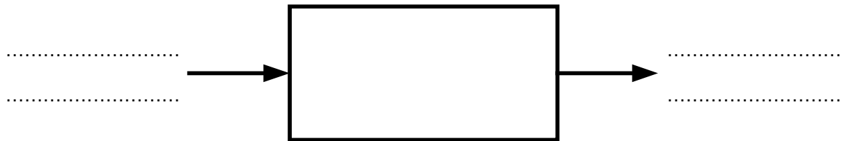
Un vérin transforme de l'énergie pneumatique d'entrée en énergie mécanique de sortie
